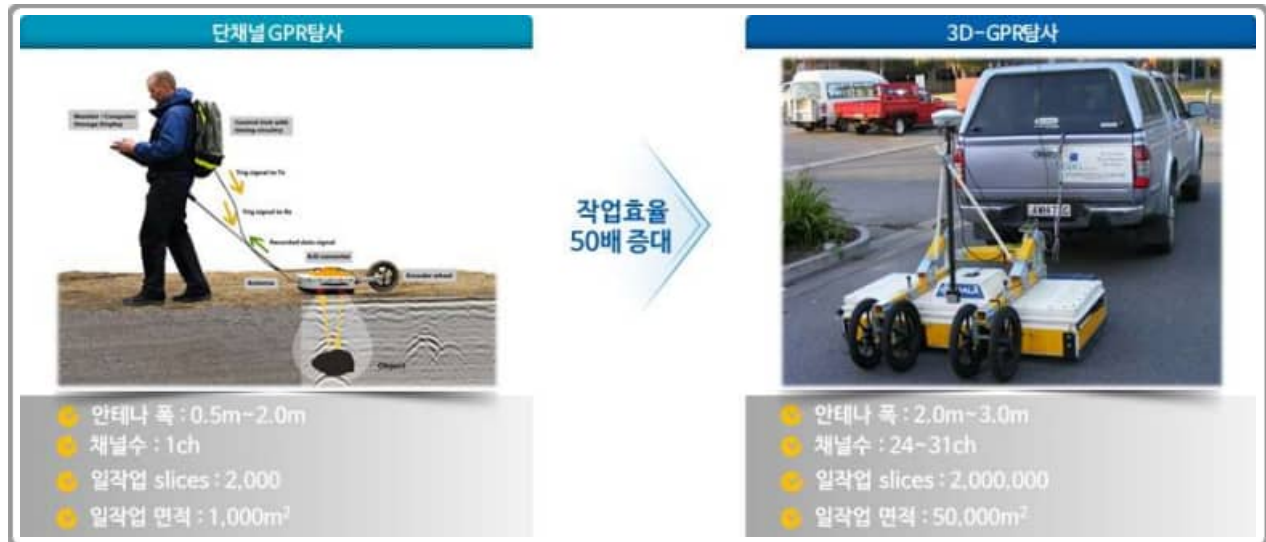
그림 2-6. 차량형 GPR 탐사의 효율성
