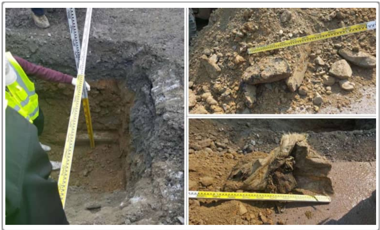
그림 3-10. 송파대로 폐기물 매립으로 인한 공동발생 사례
