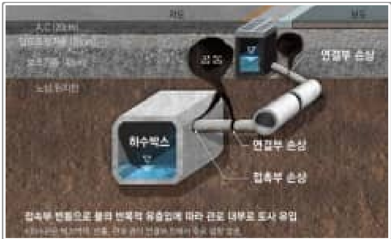
그림 3-4. 지하매설물 파손에 의한 공동발생 모식도
